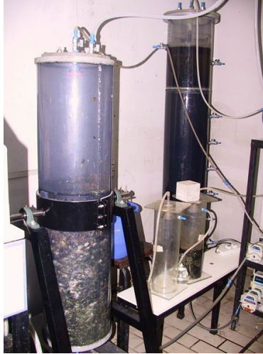
The mini pilot-scale HASL system
