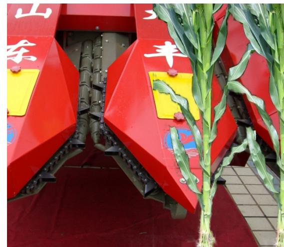
不对行收获造成的问题——降低作业效率，对辊处容易堵塞。
